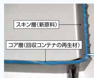
回収した使用済みコンテナを再生材として中間層(コア層)に使用し、新原料で表面(スキン層)を包み込む
