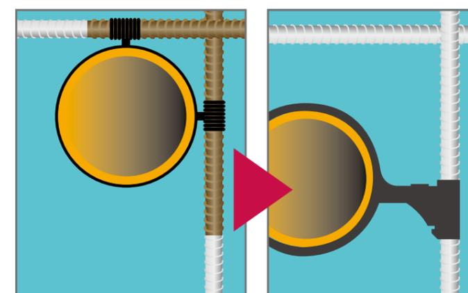
スリーブホルダーはプラスチック製のため、ボイド管を外した後に水が結束線を伝って鉄筋が錆びる心配はありません。
