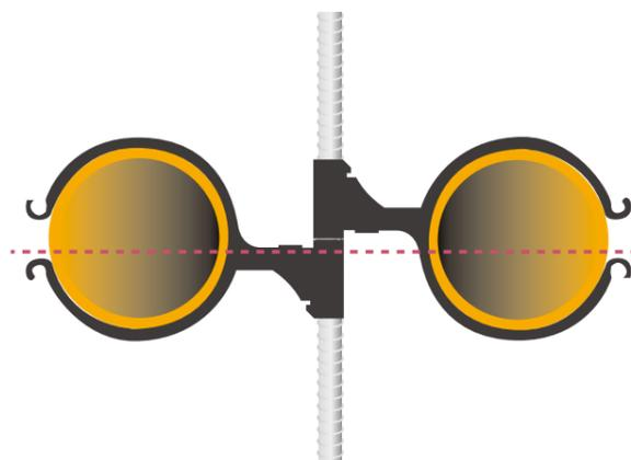
スタンダードタイプを使えば、2本のセンターを揃えて施工することも容易。平行配管の位置決め到手間取った施工時間を大幅に短縮します。
