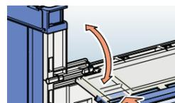
サイドゲートが開閉でき、さらに先端部が伸縮します。
