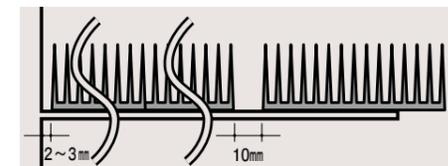
2枚連結して本体を使用する時は、次の2枚連結との間に約10mmの間隔をとってください。
