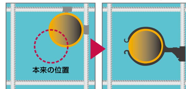
これまで、配管スリーブを型枠施工する際には、結束線で固定する方法が一般的でした。この方法だと、施工時間がかかり、本来の位置ではない場所に固定したりするケースも多くありました。スリーブホルダーなら、鉄筋に差し込むだけの簡単施工。鉄筋から離れた位置に固定でき、コンクリートのかぶり厚を一定に保つことができます。
