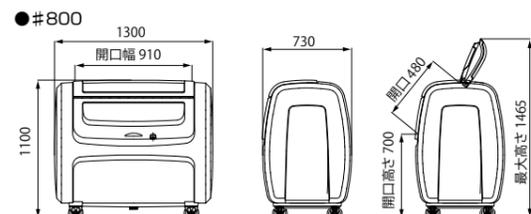
業界初の回転成型によるフタ・本体一体成型品。雨水浸入・汚水漏れ・臭気漏れを防ぎます。
